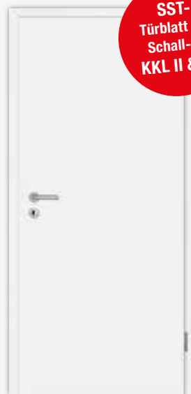
Schallschutz-Türblatt (SST) Schallschutz Klasse 1 (SD32 = Rw, P 32 dB) und Schallschutzklasse 3 (HSD43 = Rw,P 43dB) inkl. Schall-Ex, Bänder V0026WF, PZ vorgerichtet.
