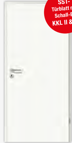
Schallschutz-Türblatt (SST), Weisslack mit Eckkante (EC), Schallschutz (Rwp 32dB), Klimaklasse II, und III inkl. Schall-Ex-Bodendichtung und Bänder V0026WF, PZ-vorgerichtet
